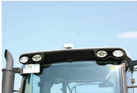
GPS-Empfänger auf dem Dach eines Traktors
