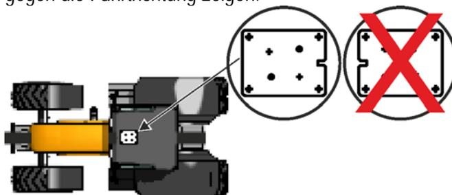
4. Legen Sie den GPS-Empfänger so auf die Magnetplatte, dass er einrastet. Der Anschluss muss dabei gegen die Fahrtrichtung zeigen.
