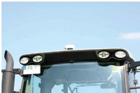
GPS-Empfänger auf dem Dach eines Traktors
