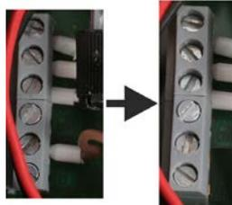
6. Isolieren Sie die entfernte braune Kabelader, weil diese unter Spannung steht.
