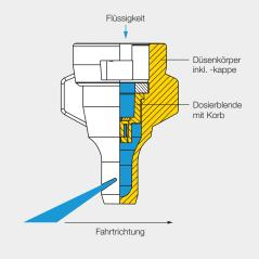
Werkzeuglos herausnehmbare Vorkammer
