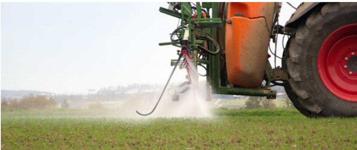
Optimale Benetzung durch den Doppelflachstrahl
