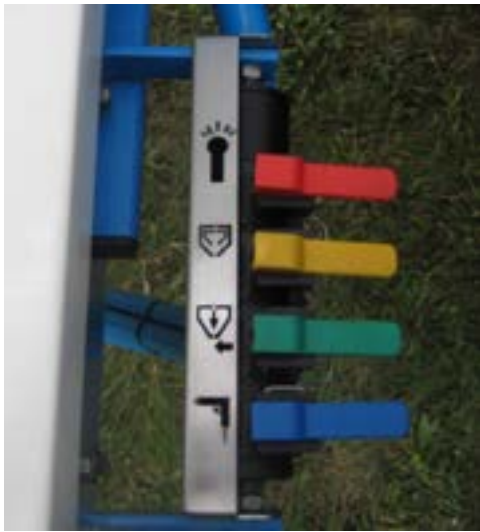
Abb. 39: 4-fach Armatur für Ringleitung/Kanisterspüler/Sumpfdüse/Handspülpistole
