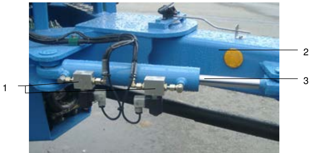
Abb. 12: Lenkzylinder für automatisch lenkbare Zugdeichsel
