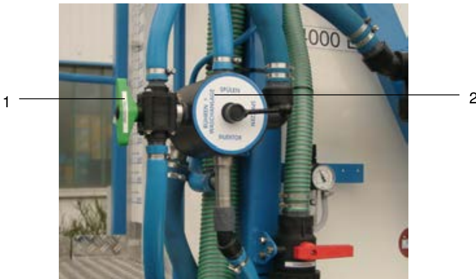
Abb. 52: 5-Wege-Kugelhahn mit Anschluss Außenwaschanlage
