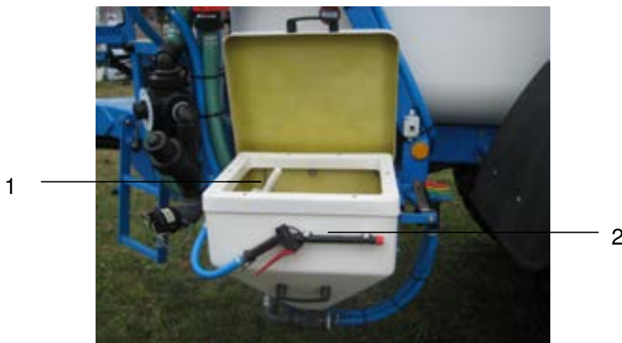
Abb. 40: Einspülschleuse mit Spülpistole und Kanisterspüldüse
