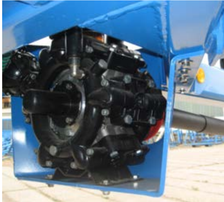
Abb. 19: Mechanischer Antrieb der Spritzflüssigkeitspumpe über Gelenkwelle
