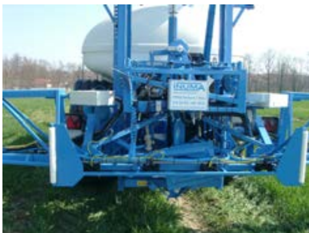
Abb. 32: Spritzgestänge ausgeklappt (Arbeitsstellung)
