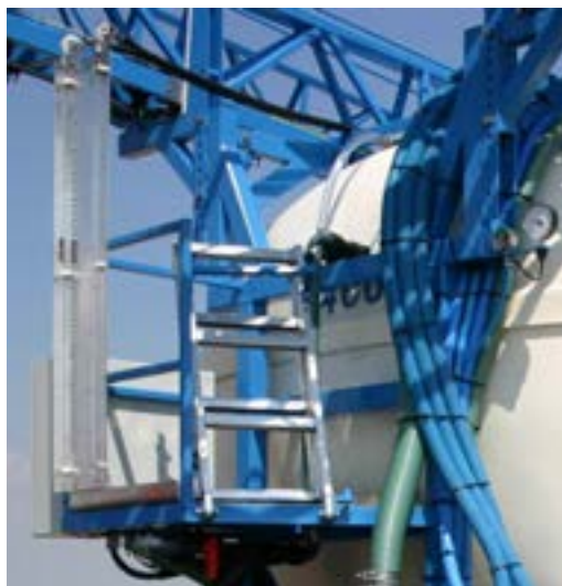
Abb. 24: Aufstiegsleiter klappbar mit Podest
