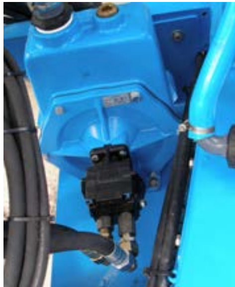
Abb. 21: HYPRO-Kreselpumpe mit hydraulischem Antrieb
