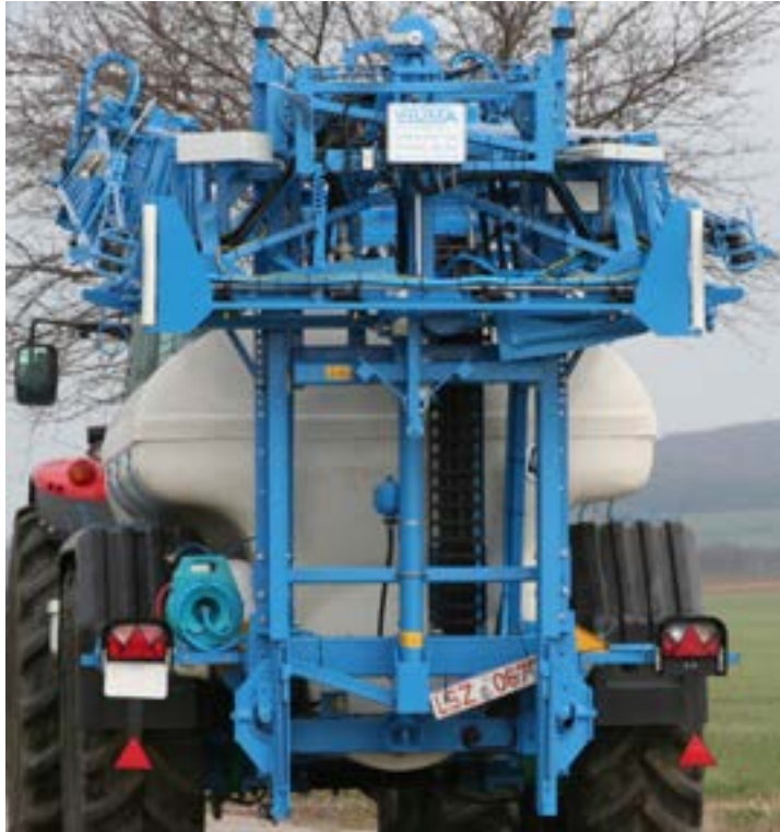
Abb. 31: Spritzgestänge eingeklappt (Transportstellung)
