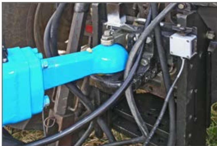
Abb. 13: Zugdeichsel mit Kugelkopf-Kupplung K80 (Option)
