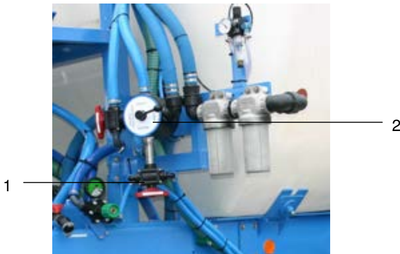
Abb. 54: 5-Wege-Kugelhahn mit Anschluss Außenwaschanlage
