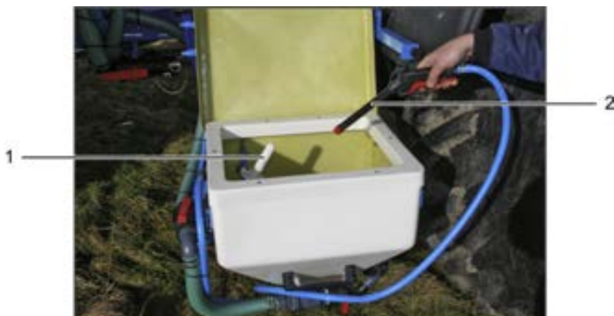
Abb. 42: Einspülschleuse mit Spülpistole und Kanisterspüldüse
