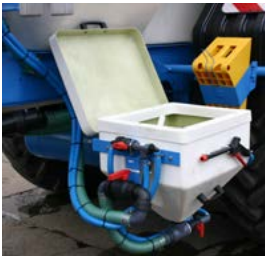
Abb. 41: Einspültrichter nach unten geklappt
