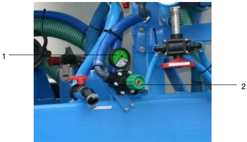
Abb. 55: Druckminderer mit Manometer
