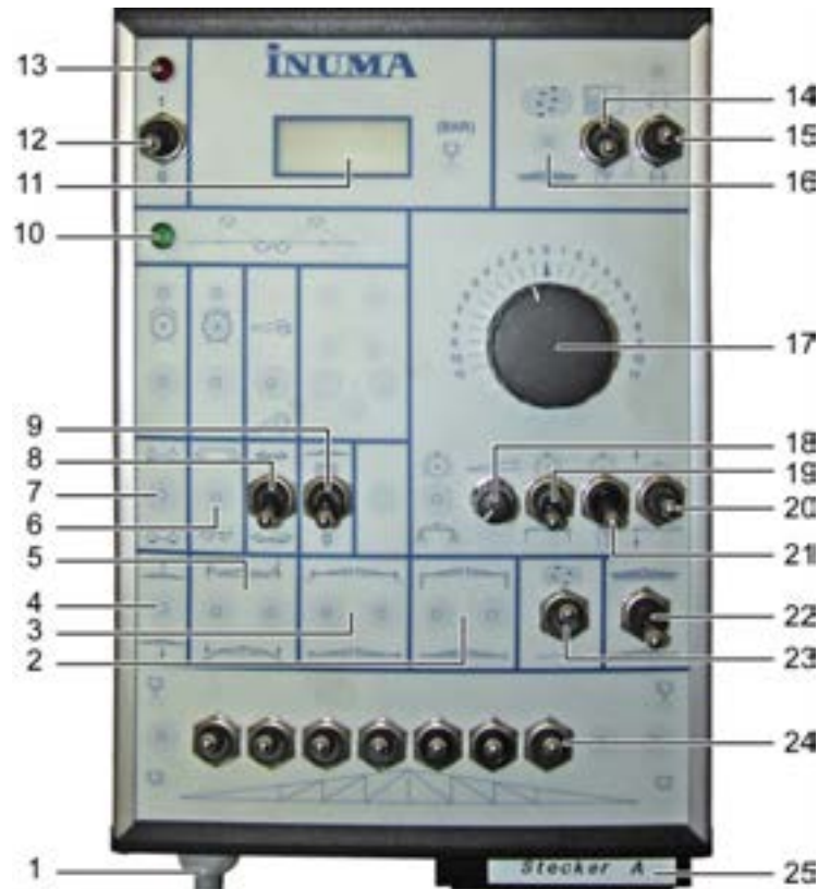
Abb. 35: Elektrischer Schaltkasten im Fahrerhaus
