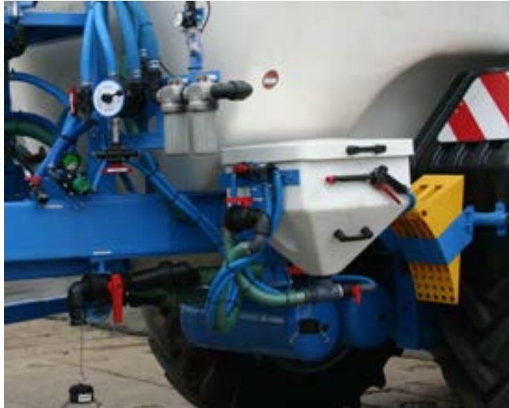
Abb. 18: Einspültrichter und Bedienteile
