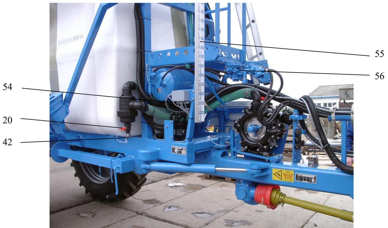
Bild 4: Bedieneinrichtungen an der Anhängespritze rechts
