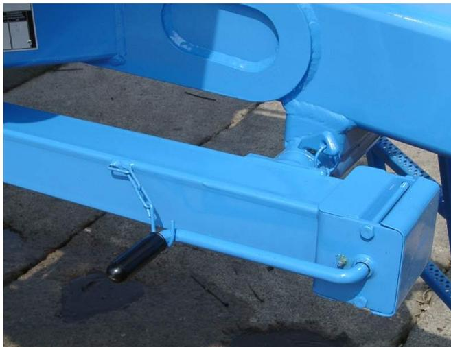
Bild 8: Stützfuß in Transportstellung gesichert
