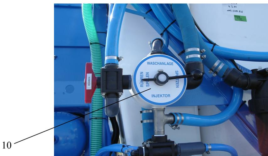
Bild 9: 5-Wege-Hahn mit Anschluß für Außenwaschanlage
