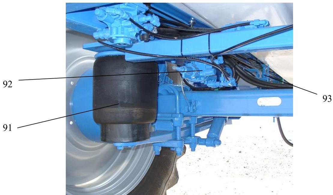
Bild 13: Luftfederanlage, Ansicht von hinten
