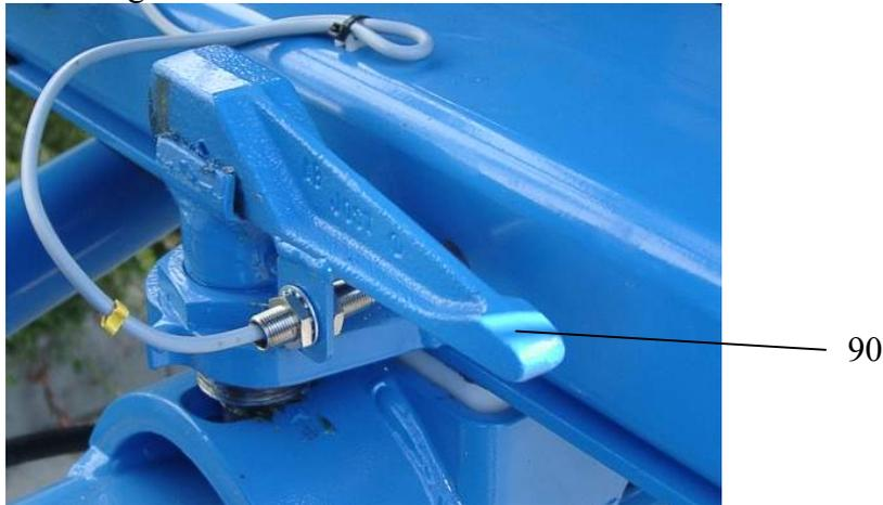
Bild 12: Mechanische Verriegelung der Deichsellenkung, ordnungsgemäß verriegelt
