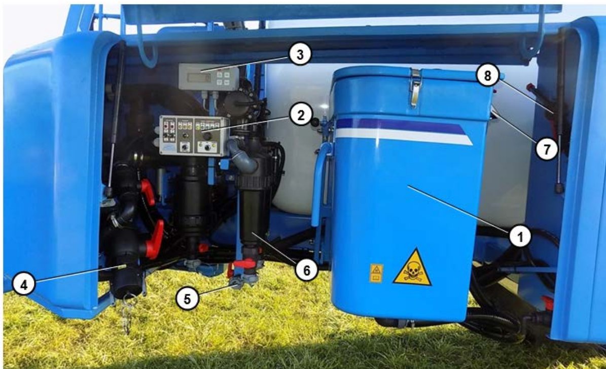
Abb. 6/4 Beschreibung der Steuerelemente der Spritze MAMUT Topline
