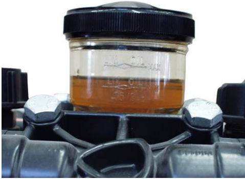
Abb. 16/7 Ausgleichsbehälter mit dem Standanzeiger
