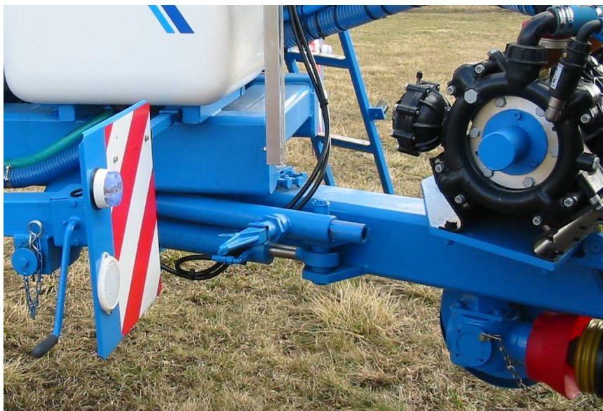
Bild.15/6 Mechanische Sicherung der Deichsellenkung – entriegelt.
