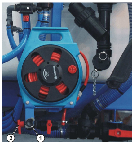
Bild 9/3 Äussere Befüllung der Klarwasser – Behälter
