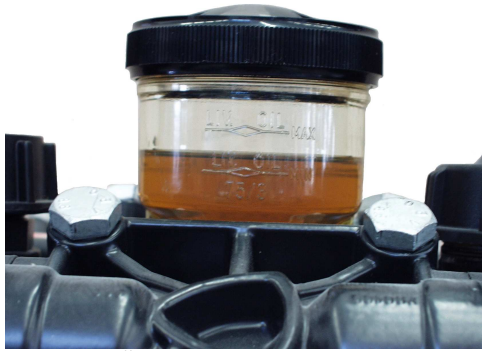
Bild. 16/7 Ölschauglass mit Füllstandsanlage
