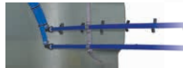
Die Injektorrührdüsen ermöglichen es, das abgelagerte Spritzmittel auch nach einer längeren Unterbrechung der Arbeit neu aufzurühren.
