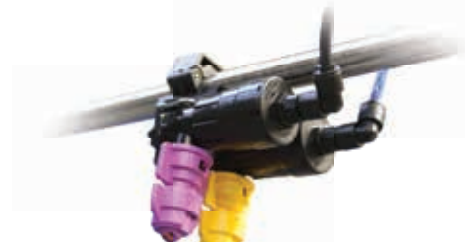
Der zweifache Selejet schaltet bei der Fahrt 2 Düsengrößen so um, dass der Druck an der Düse bei der verschiedenen Geschwindigkeit gleich bleibt.
