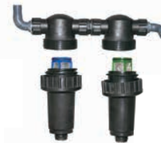
Die Zentralfiltration sichert den selben Druck an allen Düsen. Blaues Sieb 50 Maschen, Grünes Sieb 100 Maschen.
