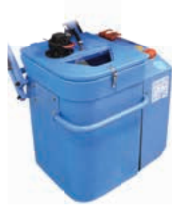
Einspülschleuse Comfort Fill. Polyäthylen, Volumen 60 l, ermöglicht den Anschluss des Adapters easyFlow für das abtropflose Eingießen von Spritzmitteln in die Spritze. Wenn es nicht möglich ist, den Adapter easyFlow zu benutzen, kann man die Einspülschleuse auch auf herkömmliche Art nutzen.
