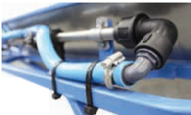
Die Zirkulation der Spritzbrühe ermöglicht die Reinigung der Druckschläuche und sorgt dafür, dass die Spritzbrühe von Anfang an direkt zur Düse gelangt.
