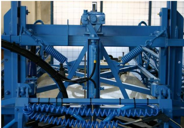
Genau in der Mitte sind die Gestänge mit Hilfe der Flacheisen auf dem Wagen aufgehängt.
