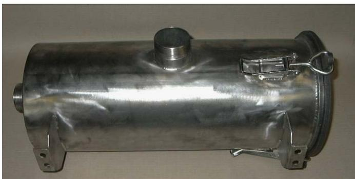
Der Einfüllluftfilter dient zur Filtrierung der Füllflüssigkeit und zur Aufnahme der groben mechanischen Verunreinigungen, der Pflanzenreste und eines anderen unerwünschten Materials. Der Filter besteht aus drei Grundteilen, aus der Außenumhüllung, dem Deckel und dem Filter (Einlage) selbst. Die sämtlichen Filterteile, die mit der beförderten Flüssigkeit in Kontakt kommen, sind gegen die Korrosion geschützt.
