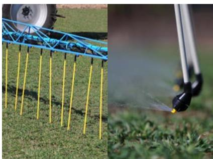
Bei der Benutzung der Schleppschläuche droht keine Gefahr der Verbrennung der oberen Pflanzenblätter. Es sind die gleichmäßige Verteilung und die präzise Dosierung des Düngemittels abgesichert.
