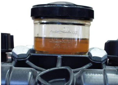
Abb. 16/7 Ausgleichsbehälter mit dem Standanzeiger
