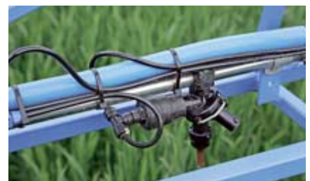
Die Düsen werden einzeln pneumatisch geschaltet, so dass ein permanenter Druckumlauf möglich ist. Beim Einsatz mit Schlepprohren verdrehen sich die Dreifachdüsenstöcke von Spraying Systems aber zu schnell (kleines Bild).
