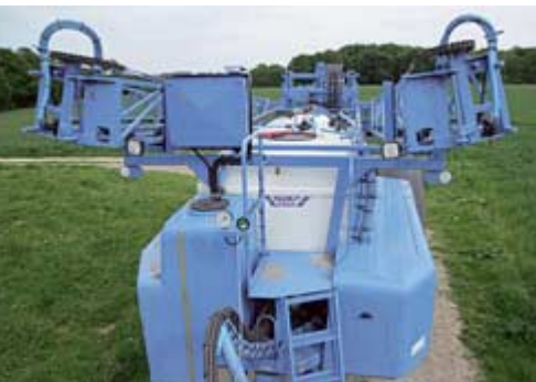
Das Gestänge kann dank endlagengedämpfter Zylinder sehr schnell geklappt werden und ragt bei 24 m nicht zu weit nach vorne. Der Füllstand im Frischwassertank vorne rechts ist nicht erkennbar, und die Leiter muss bei aktiver Lenkung immer oben sein.
