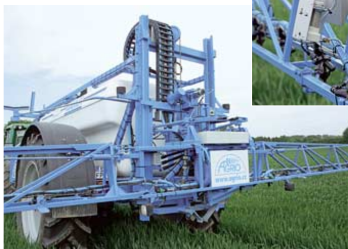
Das Gestänge im Fahrstuhl hat einen großen Verstellbereich. Die Gestängeführung „Distance-Control“ mit Ultraschallsensoren (oben) funktionierte genauso gut wie die GPS-gesteuerte Teilbreitenschaltung „Section-Control“.
