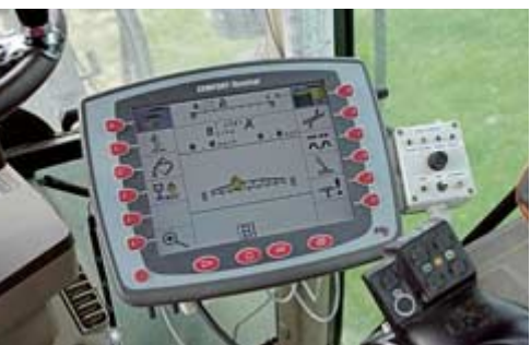
Das Comfort-Terminal samt Joystick lässt nur wenige Wünsche offen. Die Fernbedienung der Druckseite ist (noch) nicht im Terminal integriert. Auf Wunsch gibt es eine „S-Box“ zum direkten Schalten der Teilbreiten.
