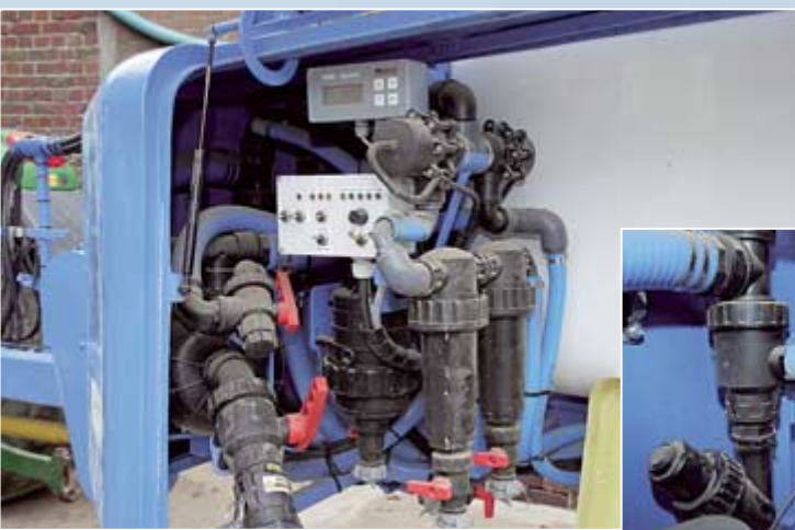
Die Bedienung ist einfach, mit der Kreiselpumpe ist die Befüll-Leistung sehr gut. Die Hauptventile werden in der „Top-Line“-Ausstattung pneumatisch geschaltet (unten).
