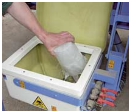
Die Einspülschleuse hat eine leistungsstarke Rühr- und Kanisterspüldüse und klappt sogar hydraulisch hoch und runter! Uns wären eine höhere Saugleistung sowie eine Beschriftung der Bedienelemente lieber gewesen.
