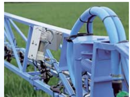
Das Gestänge im Fahrstuhl hat einen großen Verstellbereich. Die Gestängeführung „Distance-Control“ mit Ultraschallsensoren (oben) funktionierte genauso gut wie die GPS-gesteuerte Teilbreitenschaltung „Section-Control“.
