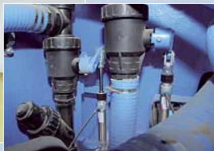
Die Bedienung ist einfach, mit der Kreiselpumpe ist die Befüll-Leistung sehr gut. Die Hauptventile werden in der „Top-Line“-Ausstattung pneumatisch geschaltet (unten).
