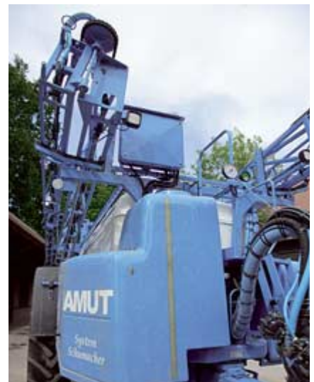
Das Gestänge im Fahrstuhl hat einen großen Verstellbereich. Die Gestängeführung „Distance-Control“ mit Ultraschallsensoren (oben) funktionierte genauso gut wie die GPS-gesteuerte Teilbreitenschaltung „Section-Control“.
