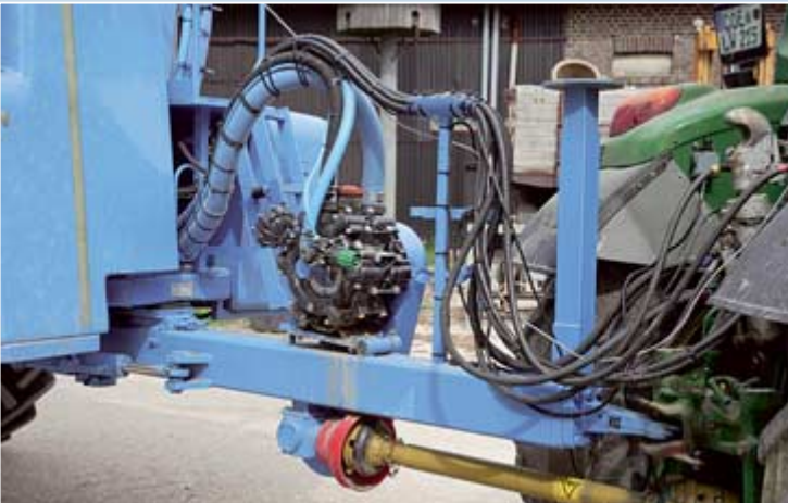
Die Anhängung ist einfach, alle Schläuche und Kabel sind ordentlich verlegt. Leider kollidiert die Stütze in Parkposition mit dem Schlepper.
