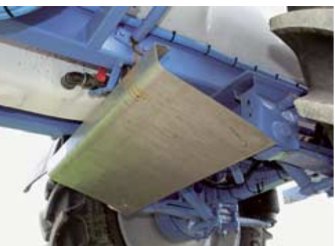
Die Bodenfreiheit ist trotz Luftfederung sehr gut, und das Blech schützt die Pflanzen zusätzlich. Die Restentleerung ist mit einem Schlauch nach hinten verlängert.
