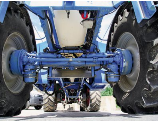
Die Achsschenkel-Lenkung funktioniert prima. Das Blech unter der Achse bietet aber nur 62 cm Bodenfreiheit.
