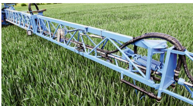
Der Ultraschall-Sensor wird so weit vorne nicht „gestört“ und klappt automatisch ein. Die pneumatische Einzeldüsen-schaltung funktioniert genau wie die stabile Anfahrtsicherung und die LED-Gestängebeleuchtung sehr gut.
