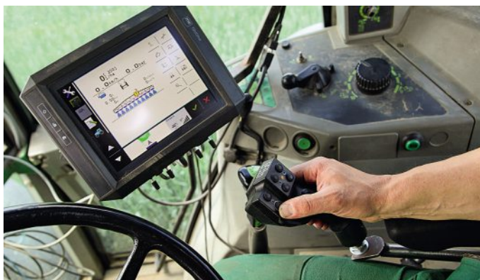
Die Bedienung mit dem Müller Touch800 sowie dem Multifunktionsgriff ist super. Zusammen mit dem TankControl, TrailControl und SectionControl bildet das System eine Einheit.
