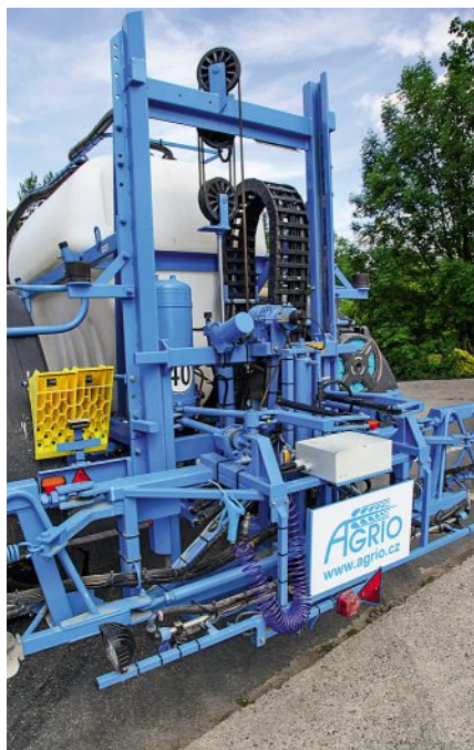
Der Fahrstuhl hat (nur) 1,92 m Verstellbereich, der elektrische Hangausgleich macht aber 12° zu jeder Seite. Und die Klappung ist dank der altbekannten (aber genialen) Kinematik mit 10 Sekunden sensationell schnell.
