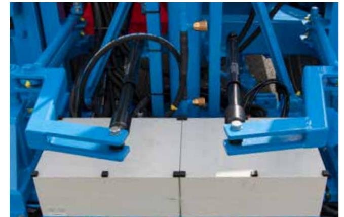
Ölstoßdämpfer verlangsamen die Bewegung des Gestänge in beiden Richtungen.
