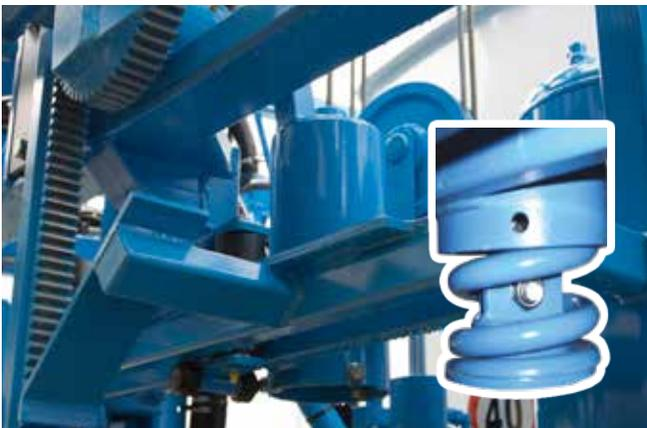
Weiche vertikale Abfederung durch Spiralfeder.
