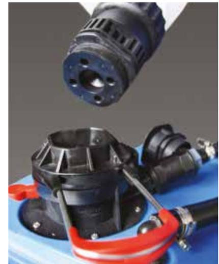
Adapter für den Deckel der Einspülschleuse (Behälter)
