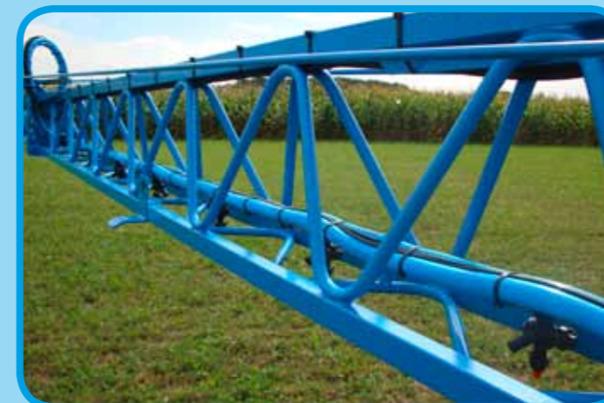
Gestänge in Dreiecksbogenkonstruktion
