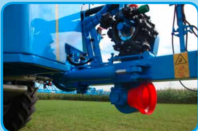
Manuelle oder automatische Deichsellenkung
