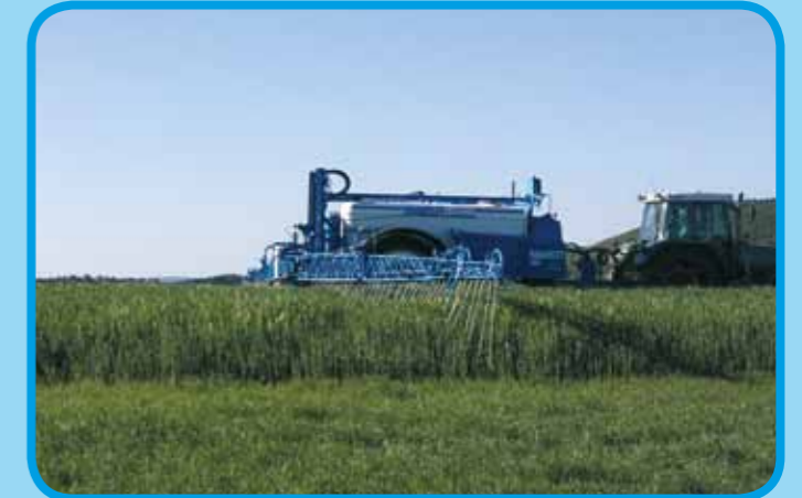
Schleppschlauchanlage mit 50 cm oder 25 cm Abstand
