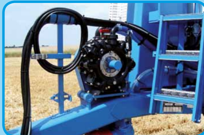
Auf die Arbeitsbreite und Einsatzzwecke angepasste AR Pumpen
