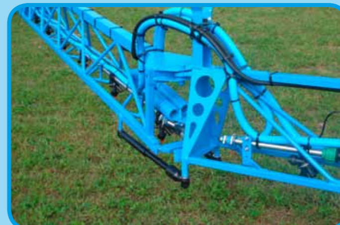
3 m Anfahrtsicherung nach vorne und hinten wirkend
