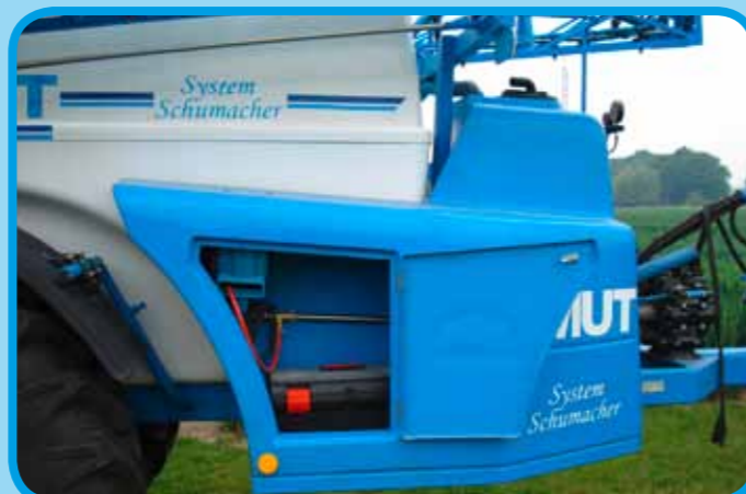
Großer Frischwasserbehälter mit integriertem Stauraum und Druckaußenwaschanlage
