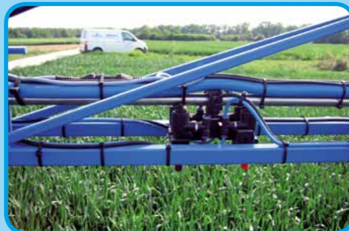
Pneumatische Einzeldüsenschtaltung und Multi-Select oder Vario-Select
