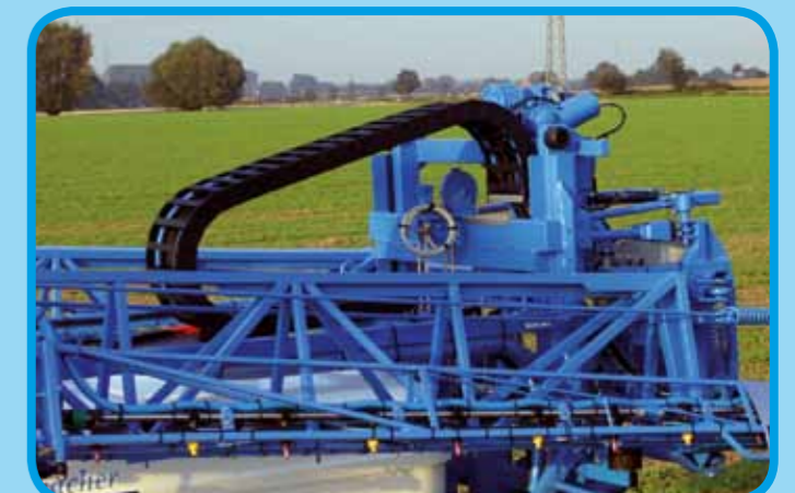
Zentrale Schlauchführung im Hubmast über Gliederkette
