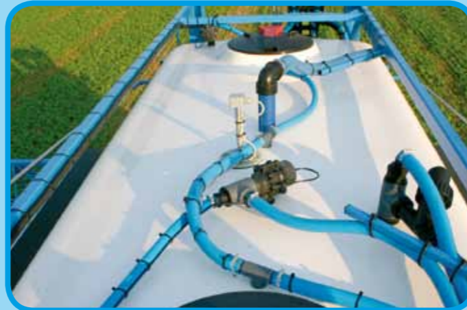
Agrio Pneumatik zur kompletten Regelung der Maschine
