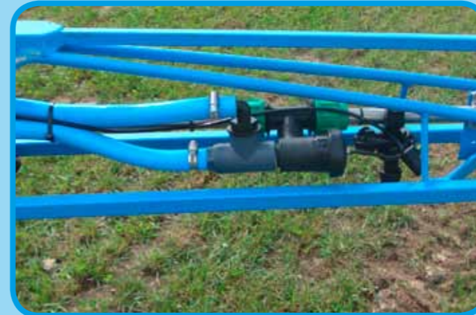
Ringspüleitung bis zur letzten Teilbreite
