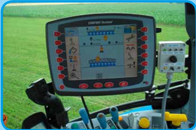
ISOBUS und automatisches Teilbreitenschalten – SECTION-Control
