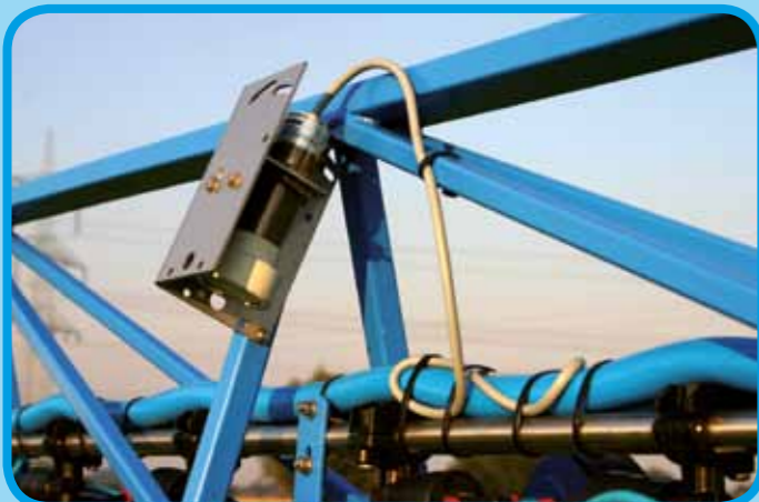
Automatische Gestängeführung über Parallelomat oder Distance-Control
