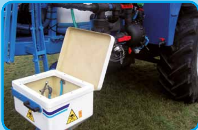
Hochklappbare Comfort Einspülschleuse
