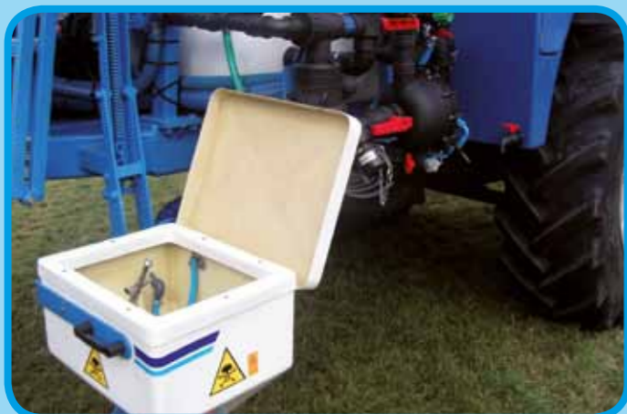
Hochklappbare Comfort Einspülschleuse
