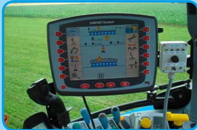
ISOBUS und automatisches Teilbreitenschalten – SECTION-Control
