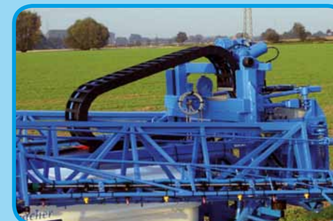
Zentrale Schlauchführung im Hubmast über Gliederkette
