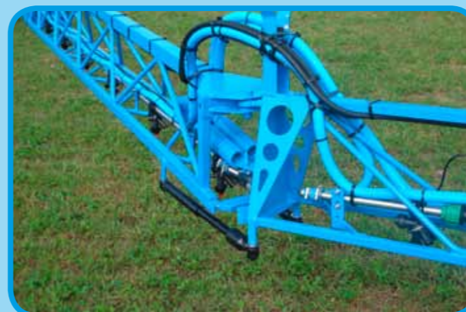
3 m Anfahrsicherung nach vorne und hinten wirkend
