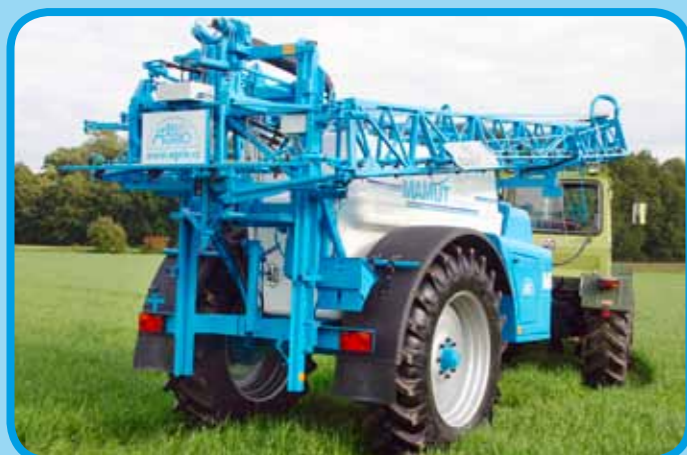
BPW Verschiebeachse, Luftdruckbremsanlage, 40 km/h
