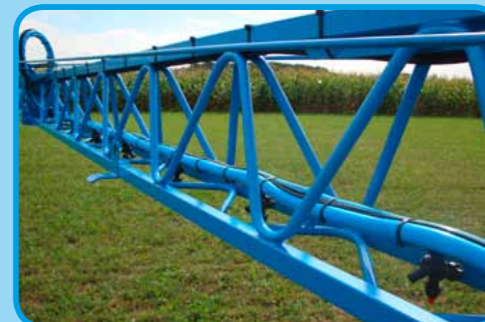
Gestänge in Dreiecksbogenkonstruktion
