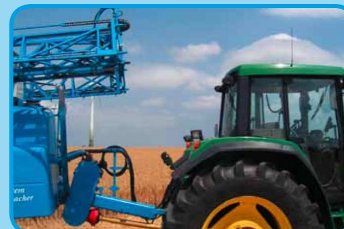
Kompakte Bauweise, das Gestänge bleibt bei Arbeitsbreiten bis 33 m hinter dem Schlepper
