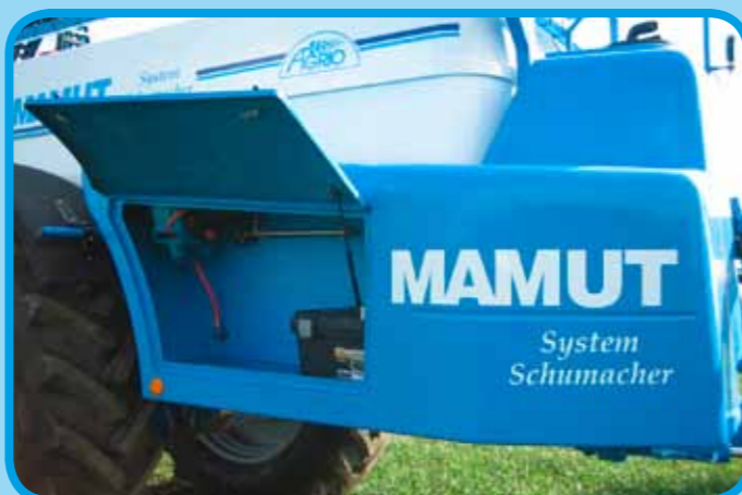
Großer Frischwasserbehälter mit integriertem Stauraum und Druckaußenwaschanlage
