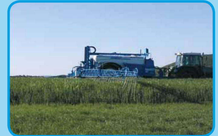
Schleppschlauchanlage mit 50 cm oder 25 cm Abstand
