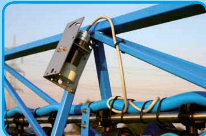
Automatische Gestängeführung über Parallelomat oder Distance-Control
