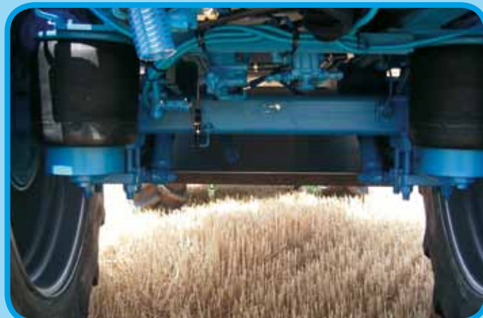
Luftgedertes Fahrwerk bis 40 km/h, Räder 520/85 R46
