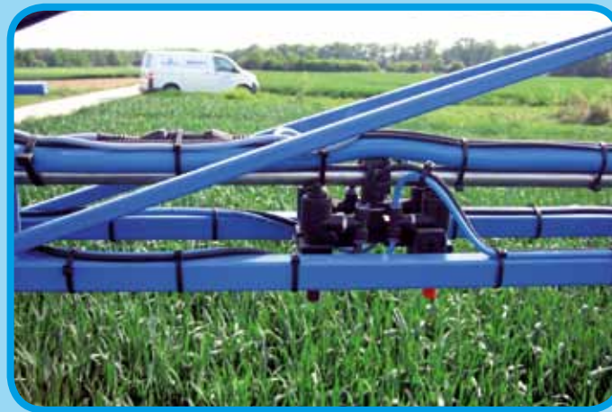
Pneumatische EinzeldüSENSCHALTUNG und Multi-Select oder Vario-Select
