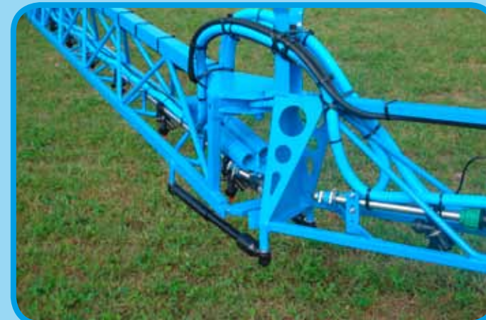
3 m Anfahrssicherung nach vorne und hinten wirkend
