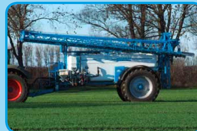
Kompakte Bauweise, das Gestänge bleibt bei Arbeitsbreiten bis 36 m hinter dem Schlepper
