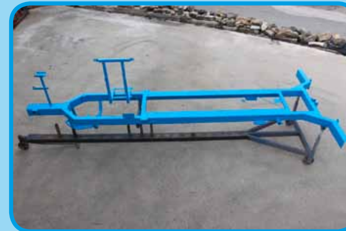
Verwindungstabiler Kastenprofil Rahmen mit Hitchanhängung
