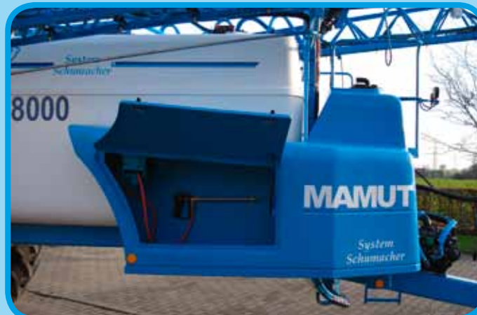
Großer Frischwasserbehälter mit integriertem Stauraum und Druckaußenwaschanlage
