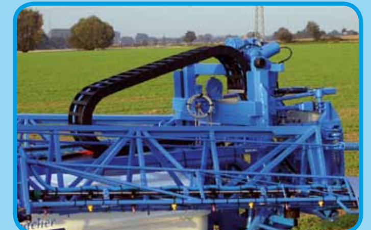
Zentrale Schlauchführung im Hubmast über Gliederkette
