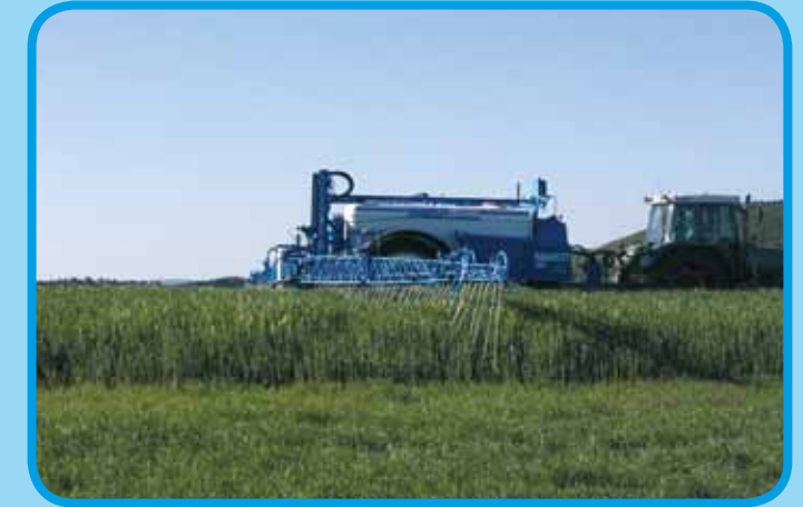
Schleppschlauchanlage mit 50 cm oder 25 cm Abstand
