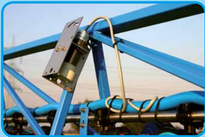
Automatische Gestängeführung über Parallelomat oder Distance-Control
