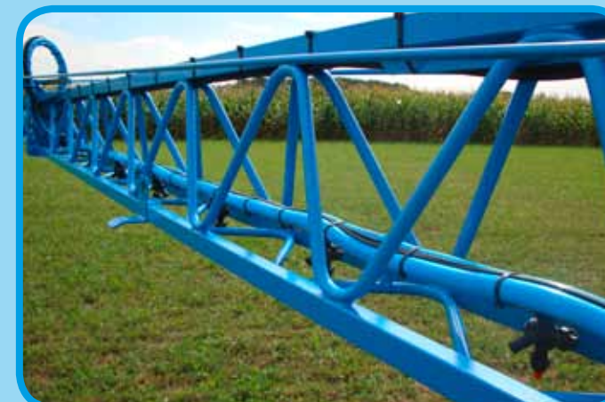
Gestänge in Dreiecksbogenkonstruktion
