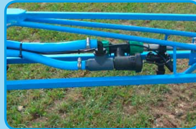
Ringspüleitung bis zur letzten Teilbreite
