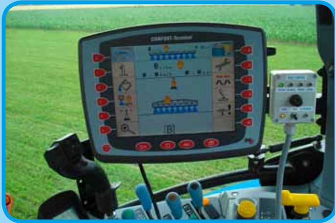
ISOBUS und automatisches Teilbreitenschalten – SECTION-Control
