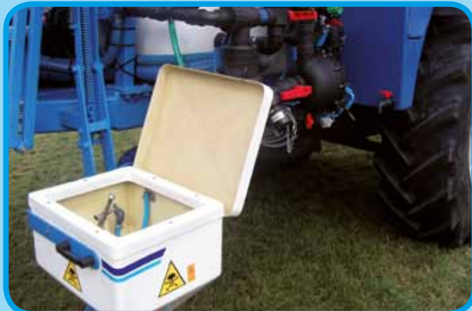
Hochklappbare Comfort Einspülschleuse
