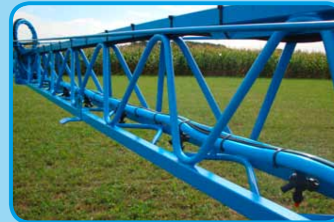
Gestänge in Dreiecksbogenkonstruktion
