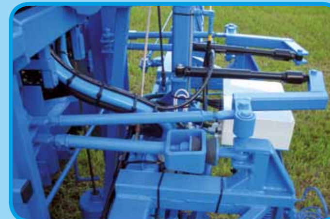
Optimale Gestängedämpfung durch die AGRIO Dämpfungskinetik
