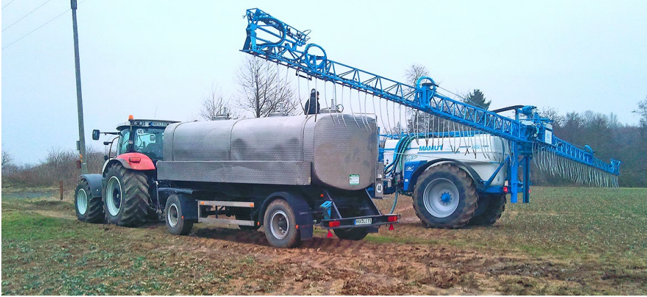
Für die Flüssigdüngung wird ein absätziges Verfahren genutzt. Der Dünger wird per Lkw an den Feldrand geliefert.
