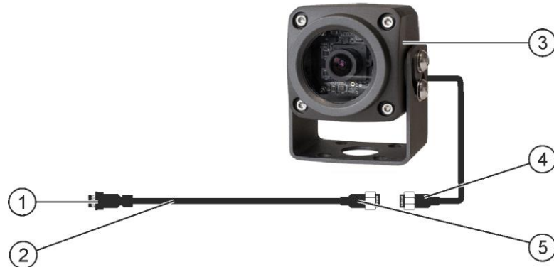
Kamera HQ2 - Anschluss an das Touch-Terminal
