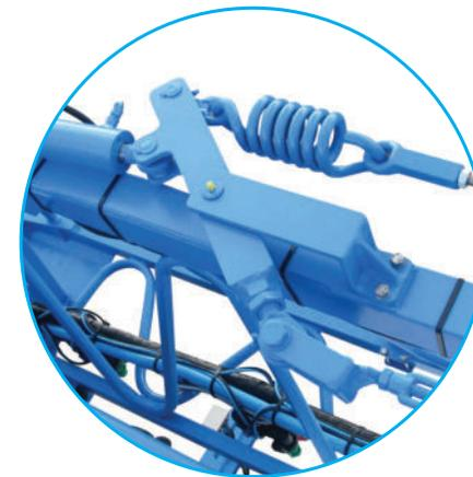
Detail der hydraulischen Umklappung nach hinten.
