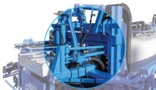
Stabilisatoren Vermeiden horizontale Schwingungskräfte. (Gummipuffer)
