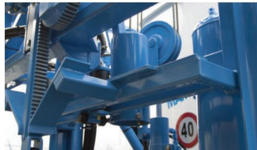
Weiche, vertikale Abfederung durch Spiralfeder.
