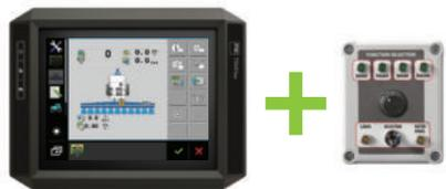
Bedienung der Saug- und Druck- Funktionen mit Hilfe der zusätzlichen Box in der Kabine.
