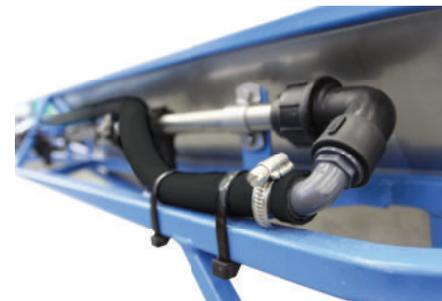
Die Zirkulation der Spritzbrühe ermöglicht die Reinigung der Druckschläuche und sorgt dafür, dass die Spritzbrühe von Anfang an direkt zur Düse gelangt.
