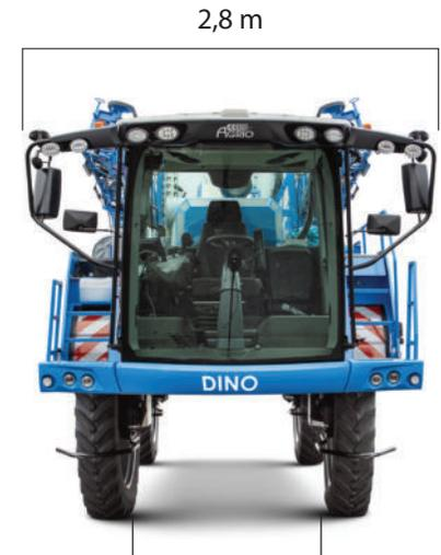
Hydraulische Spurverstellung 2,25 m
